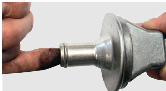
рис. 1 : Простое тестирование обратного клапана
